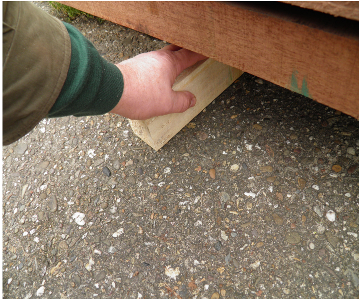
FOUT: zo kan je hand bekneld raken
